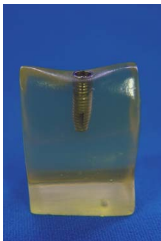
Figura 4.7 – Modelo fotoelástico contendo um análogo de implante com hexágono interno
