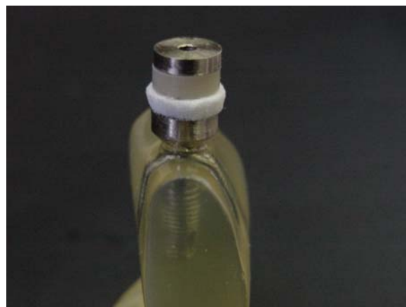
Figura 4.10 – Disco de metálico em liga de CuAl que foi posicionado sobre o corpo de prova a ser testado
