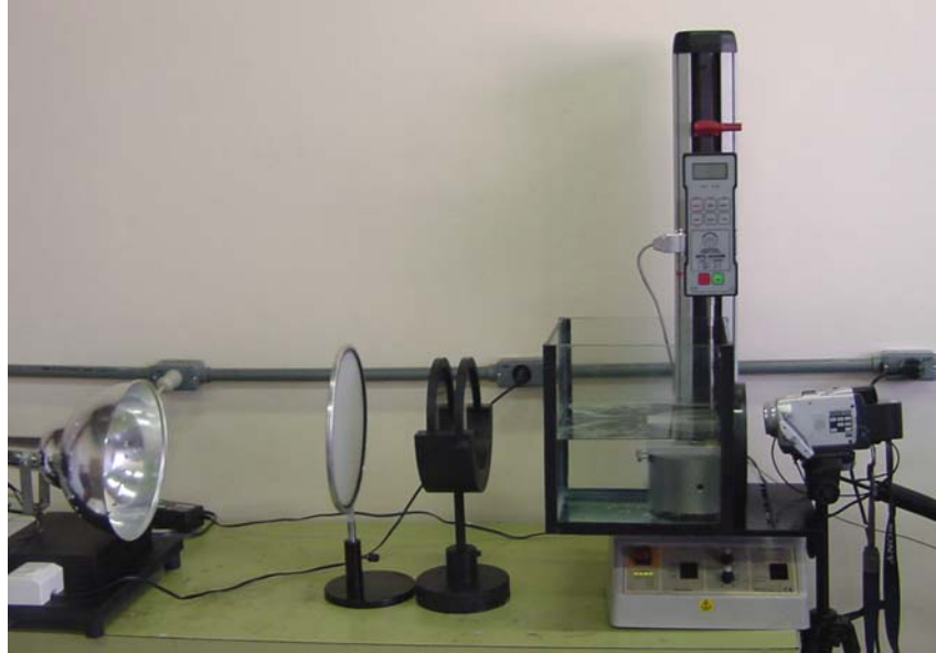
Figura 4.2 - A – Máquina de ensaios universais, B – Corpo de prova, C – Filtros polarizadores, D – Fonte de luz, E – filmadora digital, F – Aquário contendo óleo mineral
